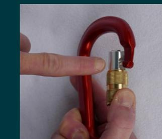
Je recherche toujours des signes de griffure, des traces de frottement métallique, des fissures... 1 mm de profondeur maximum.
