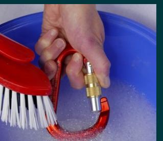
S'il y a besoin de les nettoyer, j'utilise de l'eau savonneuse tiède (30°C). J'actionne le mécanisme plusieurs fois dans l'eau.
