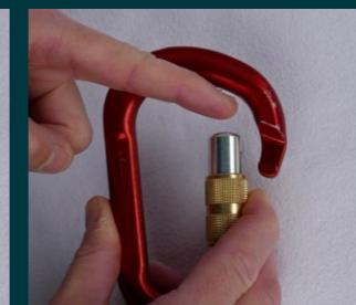
Si j'ouvre le doigt et le relâche doucement, il ne doit pas y avoir de frottement, de contrainte, le doigt doit revenir en place sans contrainte, parfaitement dans l'axe.
